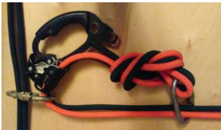
Рис. 12.3. Крепление двойным жумаром с возможностью организации снятия перил с целевой стороны этапа.
